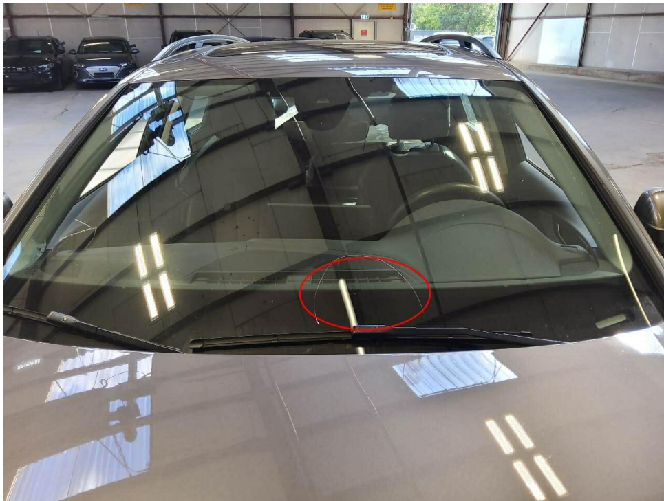
Bild 12 : Frontscheibe Steinschlag mit Rissbildung im Randbereich
