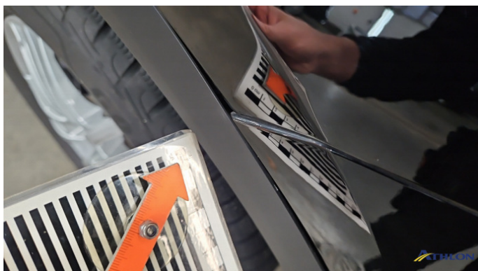
10. Radlaufabdeckung Hinten Links Spaltmaß Ungenau
