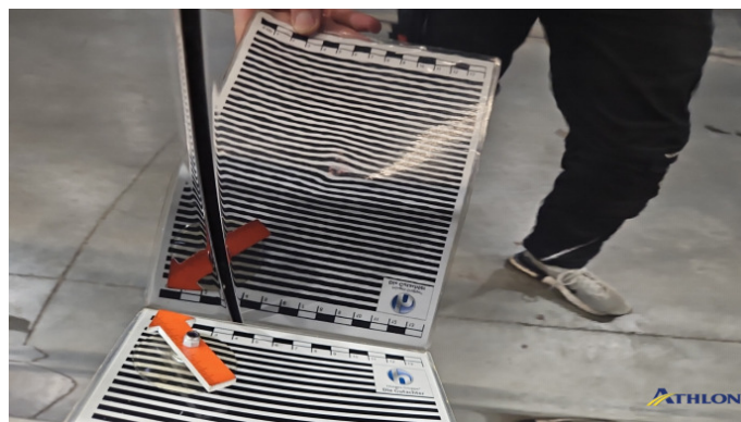
6. Tür Hinten - Links 1 Delle
