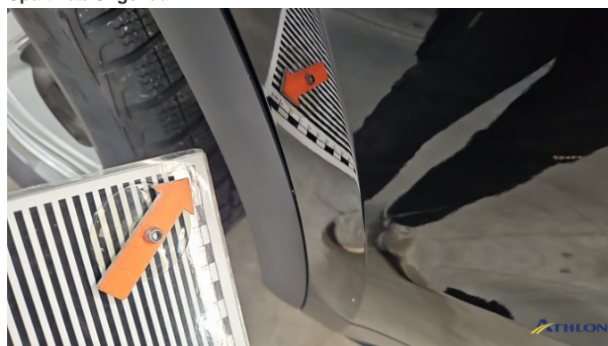
10. Radlaufabdeckung Hinten Links Spaltmaß Ungenau
