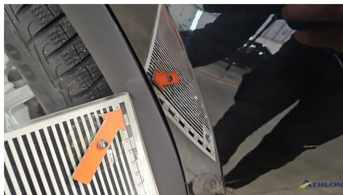
10. Radlaufabdeckung Hinten Links Spaltmaß Ungenau
